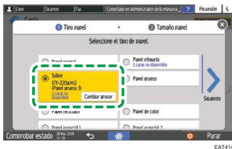
Para cambiar el gramaje del sobre, pulse [Cambiar grosor] para especificar el gramaje.
