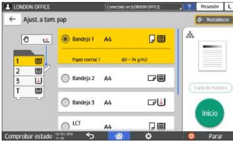
Cuando la orientación del original y el papel cargado en la bandeja de papel no coincidan, la máquina girará automáticamente la imagen copiada. Para reducir un original de tamaño A4 ( $8\frac{1}{2} \times 11$ ) a tamaño A5 ( $5\frac{1}{2} \times 8\frac{1}{2}$ ), por ejemplo, puede seleccionar A5 ( $5\frac{1}{2} \times 8\frac{1}{2}$ ) o A5 ( $5\frac{1}{2} \times 8\frac{1}{2}$ ).
