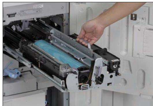
Los tres sistemas cuentan con ocho unidades Trained Customer Replaceable Units (TCRU), que los operadores capacitados pueden reemplazar rápida y fácilmente para obtener el máximo tiempo de funcionamiento en ciertos entornos.
